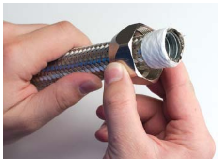
1. Вначале следует надеть на металлорукав зажимную гайку
