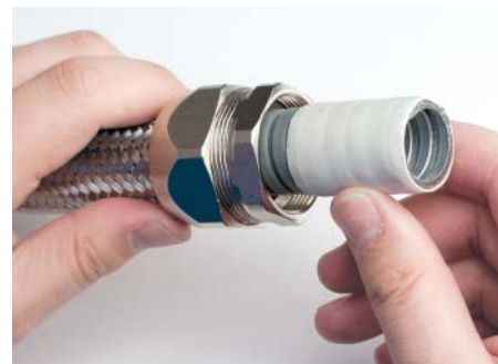
3. При использовании металлорукава в гладкой оболочке – перейти к пункту 4. При использовании герметичного металлорукава необходимо накрутить на край уплотнительную муфту для металлорукава (белого цвета) для получения герметичного соединения. Совет: сдвиньте оплетку от края для удобства монтажа уплотнительной муфты
